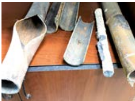
На снимке: лопнувшие экранные трубы энергетического котла
